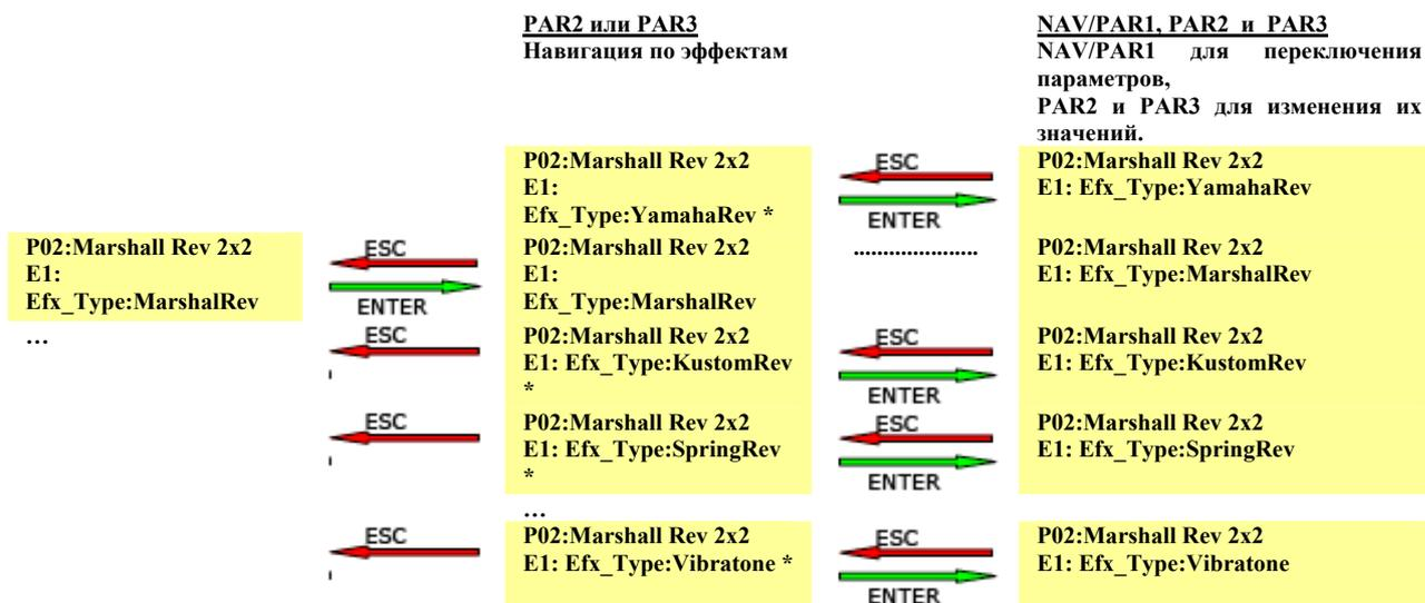
Как видно из схемы, при выборе эффекта кнопкой ENTER, он становится активным (исчезает звёздочка) и параметры этого эффекта становятся доступными для редактирования.
