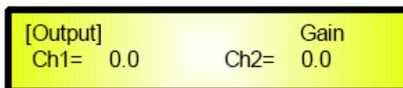
Настройка уровня выходных каналов производится с помощью регуляторов «PAR2» и «PAR3».
