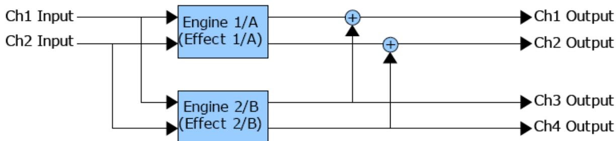
**Последовательная (Serial) конфигурация 2** (на управляющем ПК показана как 2x2 Parallel): здесь сигнал на входах процессора 1 подаётся с выходов процессора 2.
