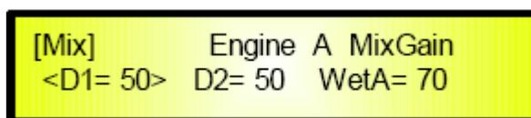
В меню «Mix» настройка микса выходов 1/2/3/4 производится регуляторами PAR2, PAR3 и NAV/PAR1.
