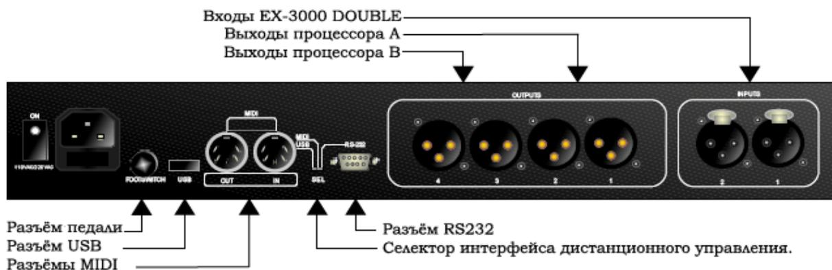
**Входы EX-3000 DOUBLE** – разъёмы XLR (тип «гнездо») для подключения источника входного сигнала.
