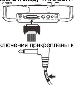
Ярлыки с указанием пэдов для подключения прикреплены к кабелям.
