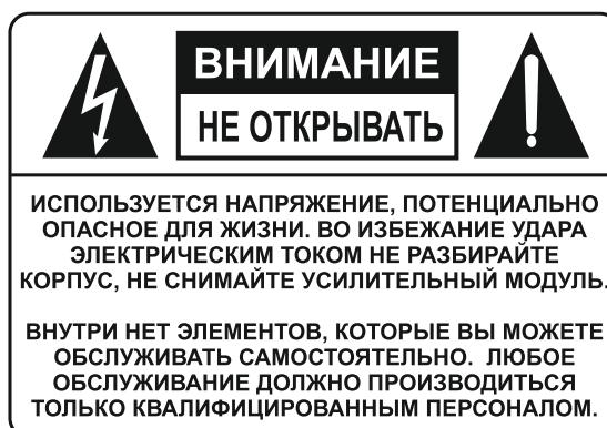
Эмблема молнии в равностороннем треугольнике означает предупреждение пользователю о наличии незаизолированного опасного напряжения в продукте, которое может привести к риску удара электрическим током.
