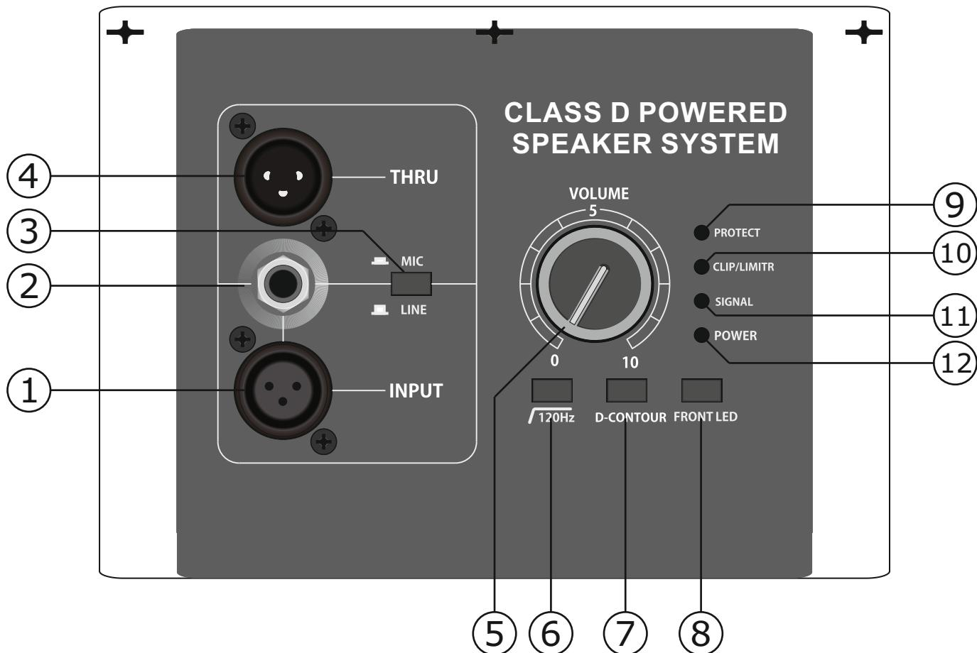
1. Балансный XLR разъем для подключения как линейных источников сигнала (например, микшерный пульт, процессор, проигрыватель и т.д.), так и микрофонов (динамических или радиосистем)
