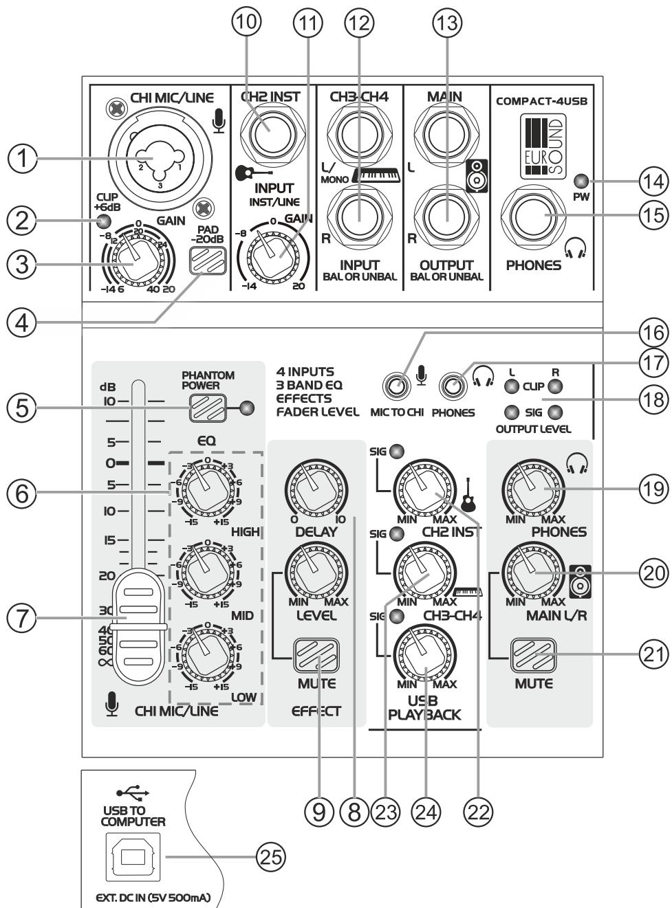
1. Комбинированный XLR/TRS универсальный вход для подключения как линейных источников сигнала, так и микрофонов, в т.ч. и конденсаторных.
