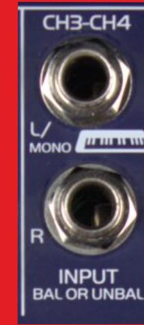
**Третий канал** – стереопара для подключения источников линейного сигнала, таких как электронные клавишные инструменты, сэмплеры, CD/DVD-проигрыватели, компьютер и т.д. Выполнен на балансных разъемах TRS.
