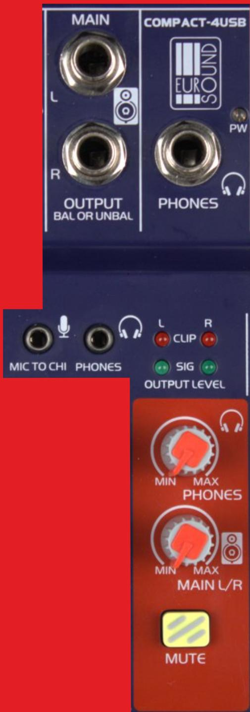
Для подключения акустических систем (мониторов) есть балансный стереовыход на разъемах TRS. Сигнал, поступающий в этот выход, также идет и на вход встроенной звуковой карты, позволяющей с помощью стороннего программного обеспечения осуществлять запись на компьютер.
