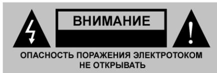
Этот треугольник на корпусе оборудования говорит о наличии внутри корпуса неизолированного опасного напряжения, достаточного для поражения электротоком.
